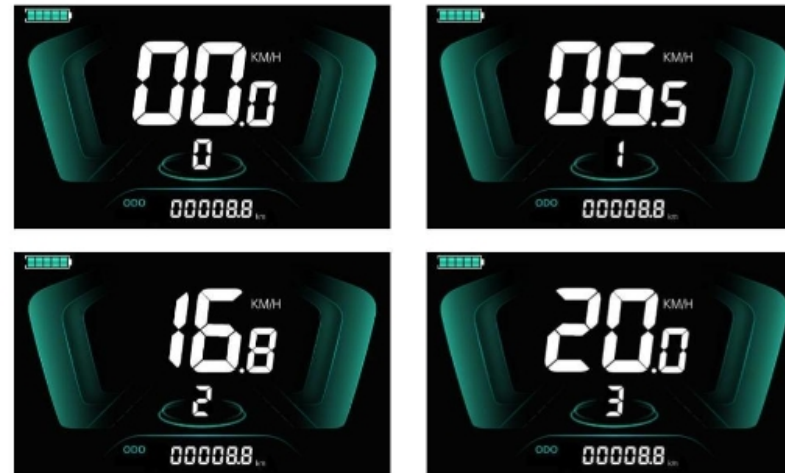
Figure 5-4 PAS level display interface
